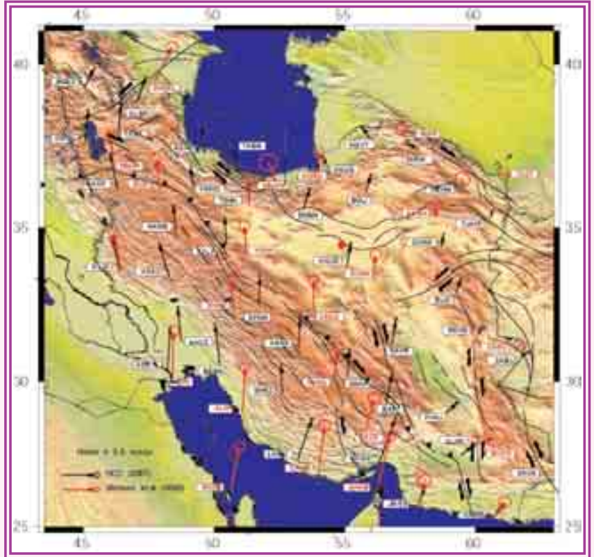
شکل ۳. شبکه اصلی ژئودینامیک سراسری ایران و میدان سرعت آن در سیستم اوراسیا
