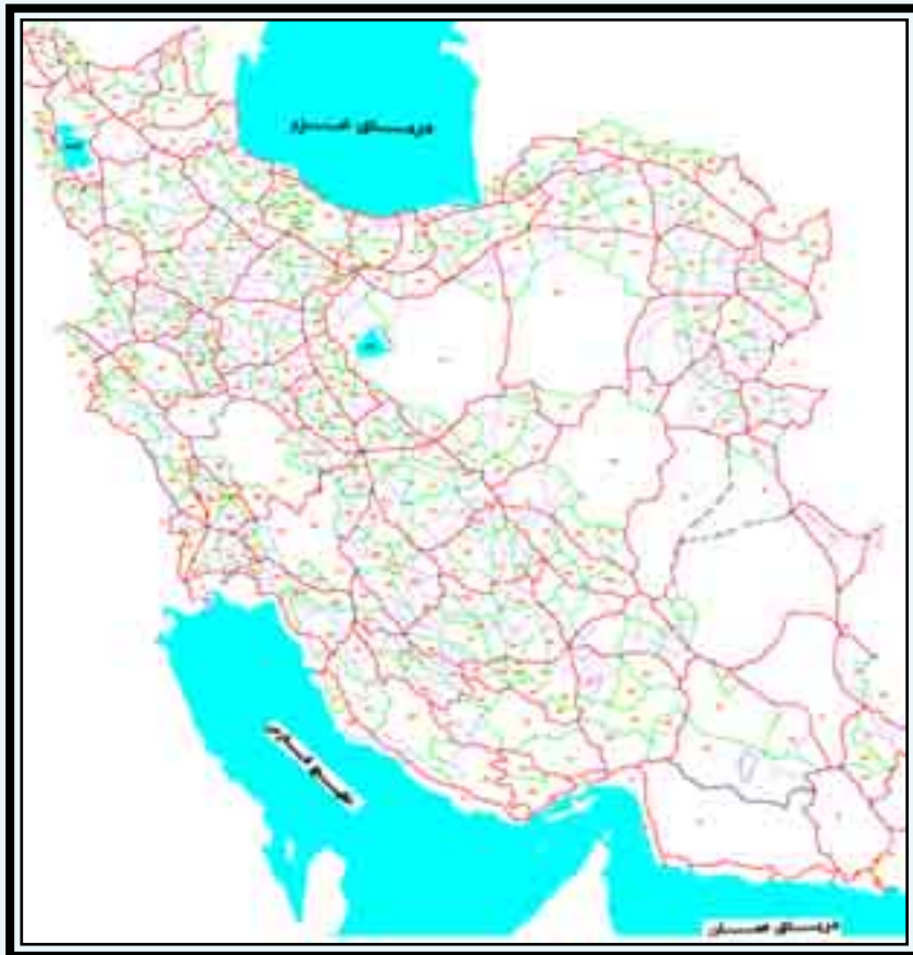
شکل ۱. شبکه های ملی ترازیبی دقیق ایران. شبکه درجه ۱ به رنگ قرمز و با طول بیش از ۳۰۰۰۰ کیلومتر، شبکه درجه ۲ به رنگ سبز و شبکه درجه ۳ به رنگ بنفش. طول شبکه های درجات ۲ و ۳ مجموعاً بیش از ۵۰۰۰۰ کیلومتر است.
