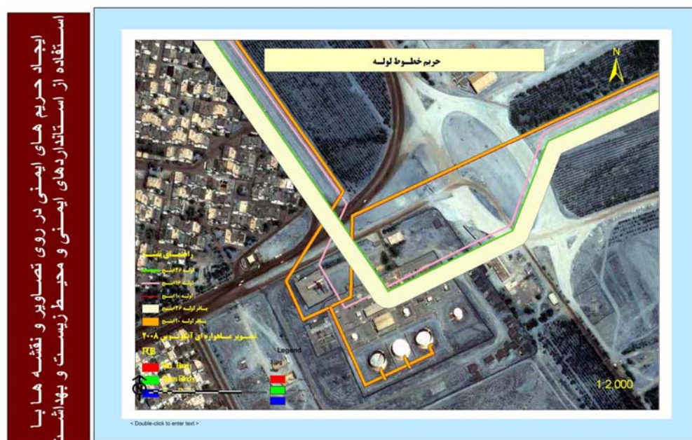
شکل ۲- ایجاد حریم های ایمنی در روی تصاویر ماهواره ای با قدرت تفکیک بالا و تحلیل حریم (Buffering) در GIS جهت نمایش مدیریت ایمنی خطوط لوله
